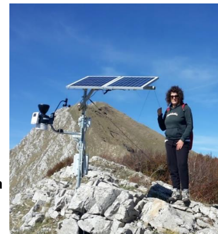
Stazione termo-pluviometrica di Belvedere posta a quota 1400 m s.l.m. (riscaldata, funzionamento h24 e dati on-line)
