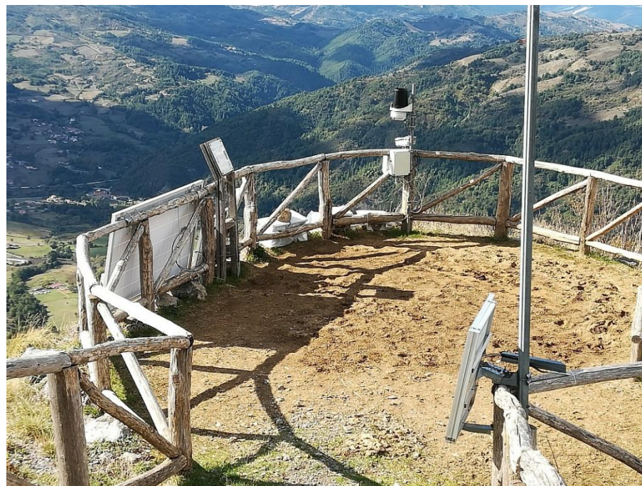
Stazione termo-pluviometrica di Belvedere posta a quota 1400 m s.l.m. (riscaldata, funzionamento h24 e dati on-line)
